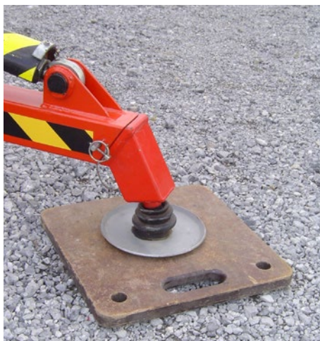
Bild 4-4 Positionierung der Stützfüße auf der Unterlegplatte
